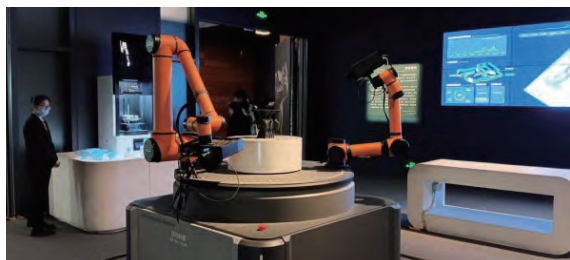
图 5- 多样性文物智能采集三维扫描平台
